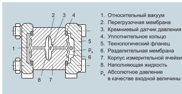
Измерительная ячейка для абсолютного давления на основе серии для измерения дифференциального давления, функциональная схема
